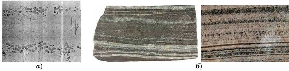
Рис. 1. Неоднорідні структури: а) – булату із сорбітною матрицею і скупченням вторинного цементиту [15], б) – гірського каменю [14, 16].
