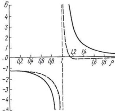
Зависимость безразмерных напряжений  $\bar{\sigma}_{rr}$  (сплошная линия) и  $\bar{\sigma}_{\varphi\varphi}$  (штриховая линия) от безразмерного радиуса  $\rho = \frac{r}{R}$  при  $z = 0$  в случае  $v = 0,25$  приведена на рисунке;  $\bar{\sigma}_{ij} = \frac{\sigma_{ij}R}{\gamma_2 - \gamma_1}$ .
